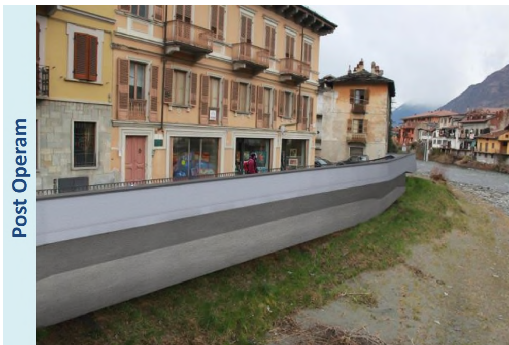
Figura 21 – Render relativo alla ricostruzione del muro di sponda a monte del ponte Vecchio.
